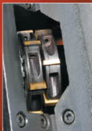
2 фрезерных диска с 6 режущими пластинами у каждого
