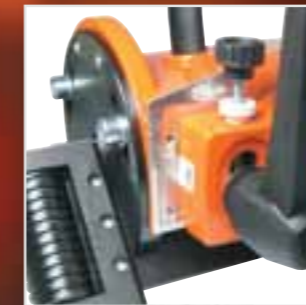
Точная регулировка глубины фрезерования/ширины фаски
