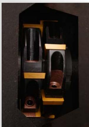
2 дисковые фрезы по 6 режущих пластин
