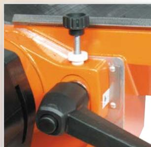
Точная настройка глубины/ширины фрезерования
