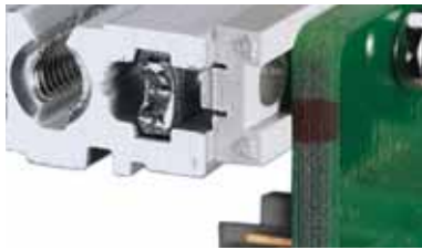
Монтаж объединительной платы с изолирующей полосой
