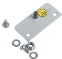
Точка заземления EMS-GP предназначена для подключения проводов заземления к вертикальному и горизонтальному профилю шкафа. Соединительная пластина привинчивается двумя саморезами к раме шкафа, чем обеспечивается надежный контакт. Подключение заземления осуществляется через резьбовой болт M6 x 16 мм.
