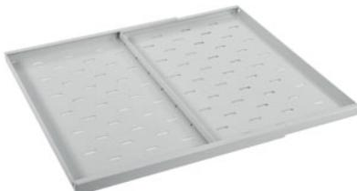
EMS-RIS предназначена для размещения нестандартного оборудования, которое требует периодического обслуживания в шкафах EMS с установленными 19" направляющими. Полки жестко устанавливаются между двумя 19" крепёжными плоскостями, и имеют изменяемую глубину для индивидуальной адаптации к расстоянию между плоскостями. Полки выполнены из листовой стали толщиной 1,5 мм. Несущая статическая способность 50 кг.
