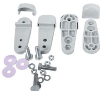
Предназначен для установки шкафов серии EP и EPV на стены зданий или другие плоские поверхности. Конструкция кронштейна обеспечивает лёгкую и надёжную установку, а также II класс изоляции при установленном комплекте. Кронштейны и защитные крышки кронштейнов выполнены из термопластичного материала (ПА).
