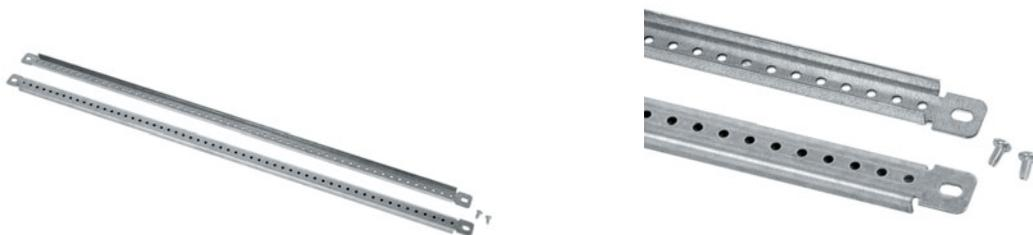
Предназначена для организации дополнительных монтажных поверхностей внутри шкафа с несущей способностью до 60 кг. Используется для фиксации кабелей и установки DIN-реек. Монтируется непосредственно на каркас без дополнительных элементов в боковых и торцевых плоскостях. Возможна установка шины при уже установленной монтажной панели.
