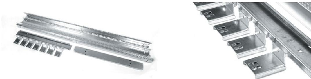
Предназначен для создания монтажного пространства в шкафах серии EMS под установку 19" (для шкафов 800-й ширины также возможны 21" и 23") конструктивов по МЭК 297 (формат 482,6 мм). Комплект состоит из 4 вертикальных направляющих для монтажа оборудования, 4 поперечных кронштейнов с возможностью регулировки по глубине шкафа, 8 монтажных кронштейнов для фиксации вертикальных направляющих на поперечных кронштейнах. Все детали выполнены из листовой оцинкованной стали толщиной 2,0 мм.
