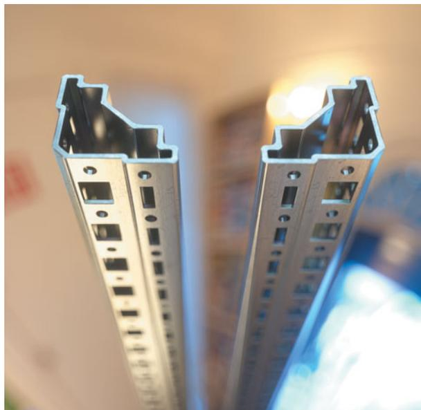
Перфорация рассчитана на использование самонарезных винтов М5 и специальных гаек М6 или М8. С внешней стороны каркаса расположены отверстия, позволяющие фиксировать петли, ответные части замка, кронштейны стенок без сверления. Также они позволяют стыковать шкафы между собой с внешней стороны, что помогает экономить время при монтаже.
