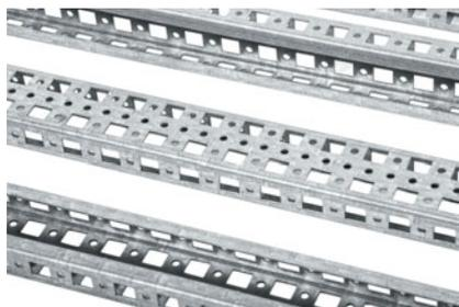
Предназначена для организации дополнительных монтажных поверхностей внутри шкафа с несущей способностью до 80 кг. Используется под установку и монтаж дополнительного оборудования. Монтируется непосредственно на каркас без дополнительных элементов в боковых и торцевых плоскостях. Возможна установка шины при уже установленной монтажной панели. Три поверхности перфорации обеспечивают широкую вариативность организации монтажного пространства.
