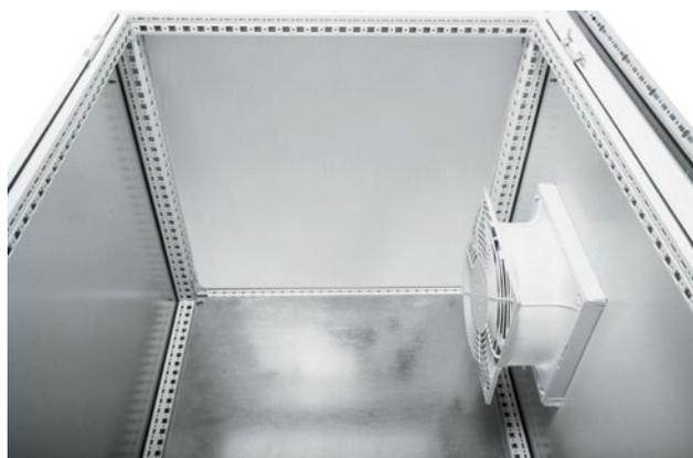
Предназначен для обеспечения климат-контроля в шкафах серии EMS путём установки вентиляторов, а также выпускных фильтров. Крепление вентиляторов и фильтров производится путём защёлкивания и не требует дополнительных крепёжных элементов.
