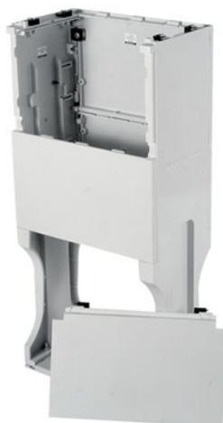
Цоколь и фундамент имеют полностью разборную конструкцию с фиксированной высотой (цоколь – 265 мм, фундамент – 890 мм) и глубиной 250 мм. За счет применения пазовых элементов обеспечивается жёсткость конструкции.
