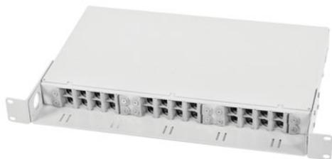
19" оптический бокс (кросс) предназначен для организации соединения до 48 волокон магистрального кабеля с абонентским. Фронтальная сторона кросса имеет площадку для удобной фиксации пигтейлов. Устанавливается в 19" шкафы и открытые стойки.
