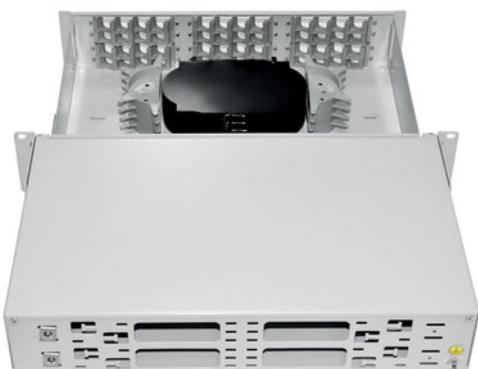
19" оптический бокс (кросс) предназначен для организации соединения до 48 волокон магистрального кабеля с абонентским. Для удобства монтажа и тестирования оптических соединений сплайс-кассета кросса выдвигается на 250 мм. Кросс устанавливается в 19" шкафы и открытые стойки.
