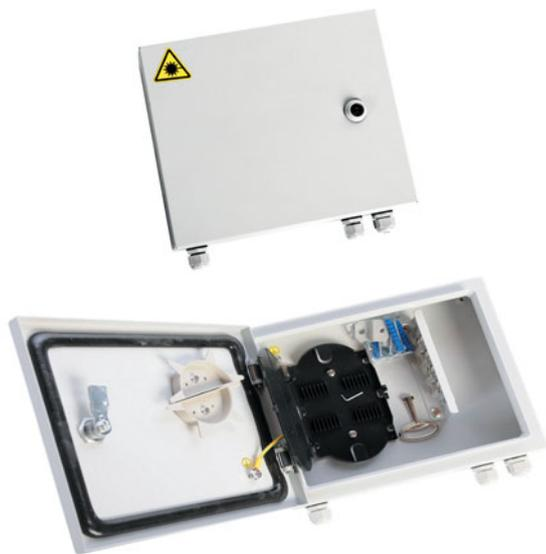
Настенный бокс БОН-Н-24.55 предназначен для организации уличного среднего узла коммутации в сетях ПОН и FTTB. Обеспечивает защиту IP55 соединения до 48 волокон магистрального кабеля с абонентским. Имеет компактные размеры (ВхШхГ) – 350х300х106.
