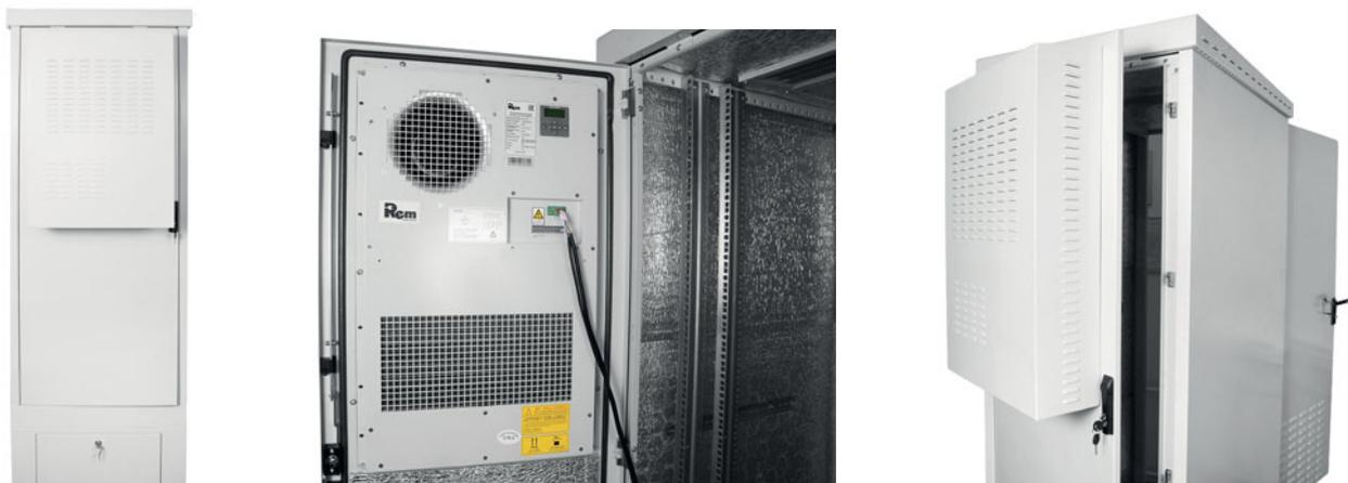
Шкафы укомплектованные серии ШТВ-1 и ШТВ-2 предназначены для размещения автономно функционирующего активного и пассивного телекоммуникационного оборудования, обеспечивают защиту от воздействия окружающей среды и несанкционированного доступа, а также поддерживают требуемый температурный режим во внутреннем пространстве. Степень защиты, обеспечиваемая оболочкой по ГОСТ 14254, не ниже IP54.
