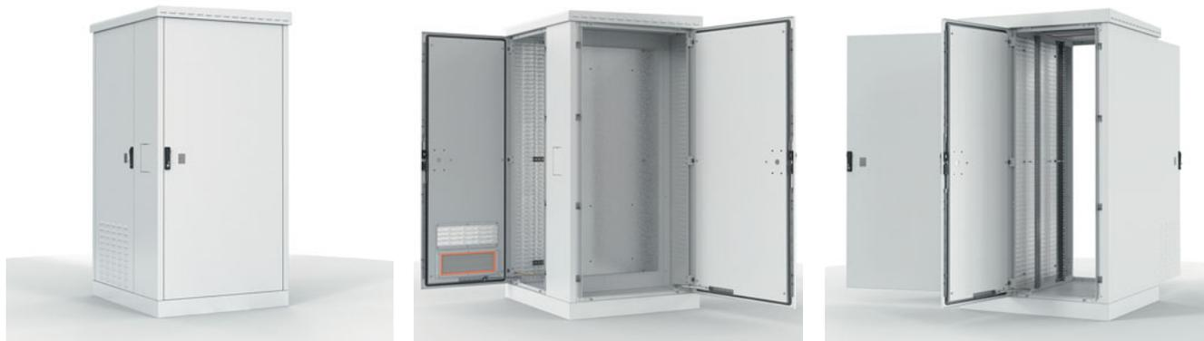
Напольный всепогодный шкаф предназначен для размещения автономно функционирующего активного и пассивного телекоммуникационного и электротехнического оборудования, обеспечивают защиту от воздействий окружающей среды и несанкционированного доступа. Класс защиты обеспечиваемый оболочкой IP65 по ГОСТ 14254-96 (при использовании вентиляции либо систем климат-контроля - IP54).
