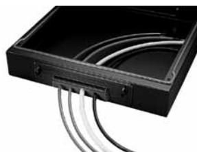
Подходит ко всем стандартным цоколям шкафов PROLINE® с высотой 100 мм для установки в ряд. Можно использовать вместо стандартных заглушек, вместе с герметичным цоколем высотой 100 мм. Размер кабельного отверстия приспособляется, для сохранения пылезащищенности. Сальник изготовлен из стали толщиной 2,0 мм и окрашен черной полиэстеровой порошковой краской RAL 9005.
