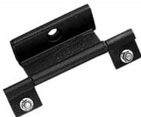
Набор опционален и служит для подвески сплошных, имеющих окошки или съемных дверей. Петля обеспечивает максимальный угол открывания двери 260° при одиночном монтаже шкафов и имеет небольшие размеры. Набор включает в себя три петли, окрашенные черной полиэфестеровой порошковой краской RAL 9005, и все необходимые крепежные детали.
