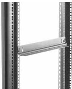
Направляющие предназначены для удобного и безопасного монтажа 19-дюймового оборудования. Поверхность направляющих имеет гальваническое покрытие. Их установка производится на 19-дюймовые профили путем навешивания и крепления накладными гайками и винтами. Крепежные детали входят в комплект поставки. Номер заказа содержит две штуки.
