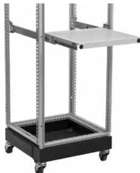
Использование выдвижной полки обеспечивает легкий доступ к установленному на ней оборудованию. Полка изготавливается из 1,5 мм стали. Все детали полки окрашены серой текстурной полиэфирной порошковой краской RAL 7035. Полка крепится к передним и задним стойкам каркаса. В объем поставки входят все необходимые компоненты для монтажа. Максимальная грузоподъемность 50 кг.
