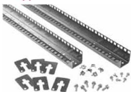
19-дюймовый монтажный профиль с квадратной системной перфорацией под закладные гайки изготавливаются из 2 мм стали с гальваническим покрытием. Установка профилей производится непосредственно на каркас шкафа шириной 600 мм. Для их монтажа в шкафах шириной 800 мм необходимо использовать кронштейны для уменьшения ширины.
