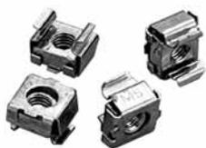
Закладные гайки предназначены для монтажа оборудования на 19-дюймовые монтажные профили с квадратной системной перфорацией. Изготавливаются из стали с гальваническим покрытием.
