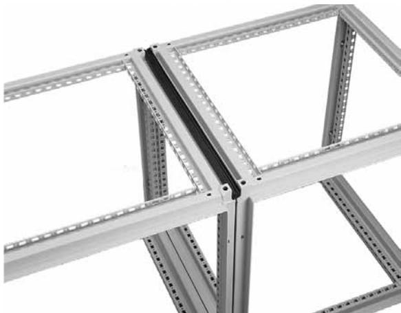
Набор соединительных элементов позволяет сохранить IP-защиту при установке шкафов в ряд. Стандартный набор состоит из шести закладных гаек и винтов, а также уплотнительного материала для поддержания пыле- и водонепроницаемости между соединенными стойками. Используются в случаях, когда 19-дюймовые держатели не установлены в крайнем переднем или в крайнем заднем положении, или монтажные панели не находятся в крайнем заднем положении.
