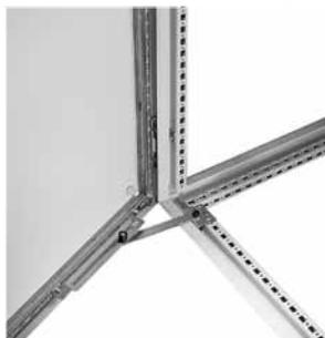
Дверь может быть зафиксирована под углом 130°. Набор включает в себя кронштейн и стопорящую консоль и содержит все необходимые крепежные детали. Монтаж ограничителя производится без дополнительного просверливания отверстий и возможен как в верхней так и в нижней части шкафа. Не пригоден для использования шарниров с углом открывания 180°.
