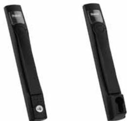
Оptionальные поворотные ручки для любого типа дверей с трехточечным запираением. Эргономично сконструированные, они сочетают стиль и функциональность с небольшими размерами. Ручки, выполнены из литого цинка и окрашены черной полиэфестеровой порошковой краской RAL 9005. Существует возможность добавления логотипа. Вращаться ручка может по часовой или против часовой стрелки.
