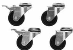
Набор из четырех роликов (два ролика с фиксацией, два — без фиксации), монтируется непосредственно с нижней стороны каркаса PROLINE или 100-мм герметичного цоколя. Не следует использовать при стандартном цоколе. Установка роликов увеличивает высоту шкафа на 110 мм. Основа роликов стальная с шарикоподшипником на оси. Колеса роликов выполнены из черного полиамидного материала. В комплект поставки входят крепежные детали M12. Максимальная грузоподъемность четырех роликов 450 кг.
