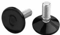
Четыре регулируемые по высоте опорные ножки позволяют компенсировать неровности пола. Ножки могут крепиться с нижней стороны каркаса или герметичного цоколя. Металлический стержень ножки имеет пластиковую головку (шаровой наконечник), чтобы не повредить установочную поверхность. Диапазон регулировки по высоте составляет 17-35 мм. Максимальная грузоподъемность четырех ножек 450 кг.
