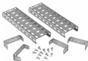
Монтажные рельсы изготавливаются из 2 мм стали с гальваническим покрытием. Они имеют, расположенные с шагом в 25 мм, прямоугольные отверстия для использования закладных гаек при монтаже оборудования. В наличии имеются рельсы с одним или тремя рядами прямоугольных отверстий и поставляются попарно. Также в комплект поставки входят крепежные элементы для установки рельсов на раму шкафа или соединения между собой.
