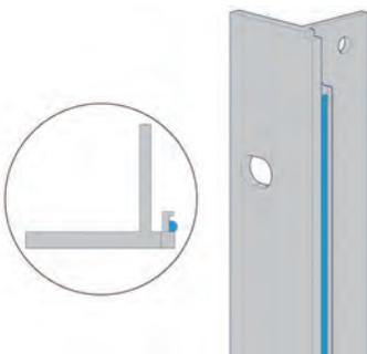
**Экранирование при помощи текстильной ЭМС-прокладки**
