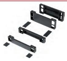
Описание: Фронтальные и задние панели цоколя. Для кабельной проводки в соответствии со стандартом VDE 0113. Цоколь состоит из 4 угловых элементов со съемными фронтальными крышками. Боковые панели PS заказываются отдельно. Выпускаются 100 мм и 200 мм высоты. Цоколи высотой 200 мм поставляются с двумя съемными панелями высотой 100 мм. Передняя панель целиковая, высотой 200 мм. Все панели имеют двойную окантовку.
